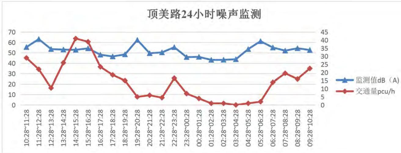
图 5.3-3 顶美路桩号 K0+730 右侧连续监测交通噪声值和交通量随时间变化曲线图
